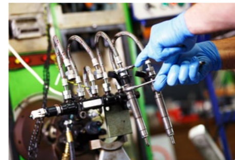
Při podezření na závadu se rovnoměrnost rozprášení prověřuje na kontrolní stanici
