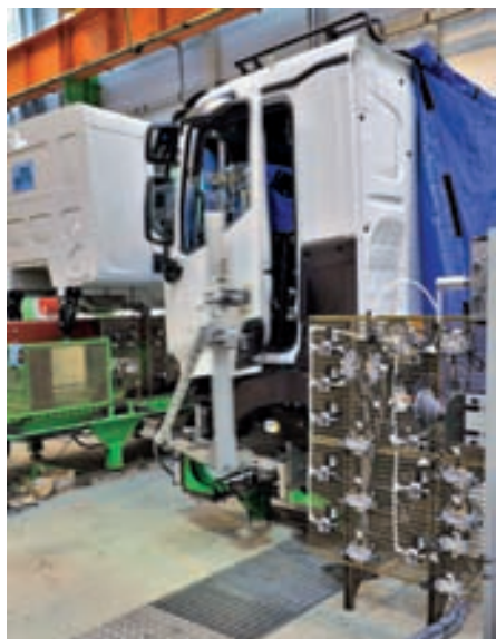
↑ Testy otevírání dveří a sklopení kabiny se opakují až 2 500 krát po sobě.
