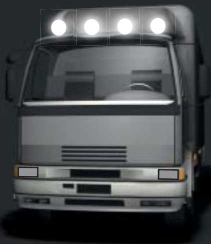
Vybavení: ☒☒ / ○○○○ 2 x SF ref. 17,5 (2x odpojeno) + 4 x ZF ref. 17,5 Celkový součet = ref. 70 (dovolen)
