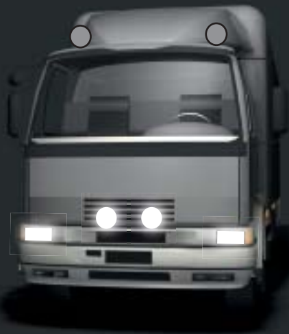
Vybavení: ☒☒ / ○○ / ●● 2 x SF ref. 17,5 + 4 x ZF ref. 17,5 (2x odpojeno) Celkový součet = ref. 70 (dovolen)
