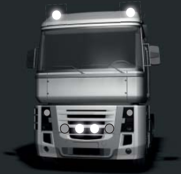
Vybavení: ⊗ ⊗ / ● ○ ○ ○ ● / ○ ○ 2 x SF ref. 37,5 (2x odpojeno) + 2 x ZF ref. 17,5 + 4 x ZF ref. 25 (2x odpojeno) Celkový součet = ref. 85 (dovolen)
