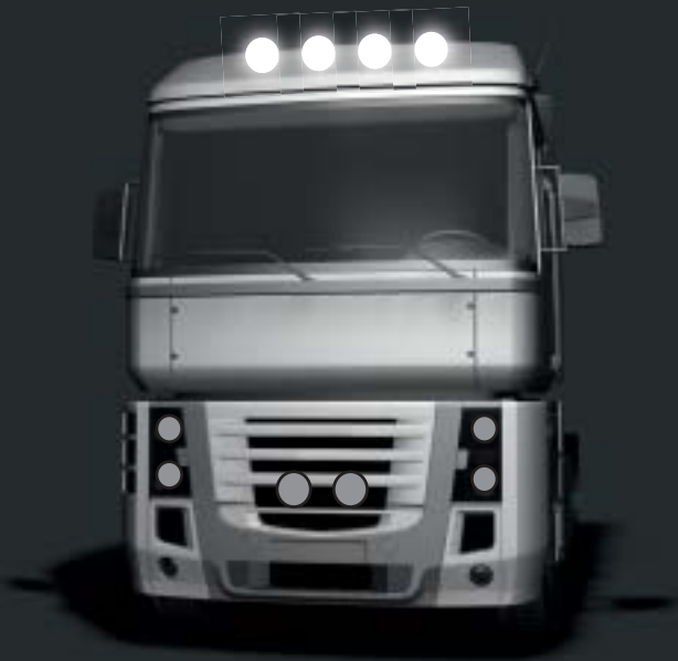
Vybavení: ⊗ ⊗ ⊗ ⊗ / ● ● / ○ ○ ○ ○ 4 x SF ref. 17,5 (4x odpojeno) + 6 x ZF ref. 25 (2x odpojeno) Celkový součet = ref. 100 (max. dovoleno)
