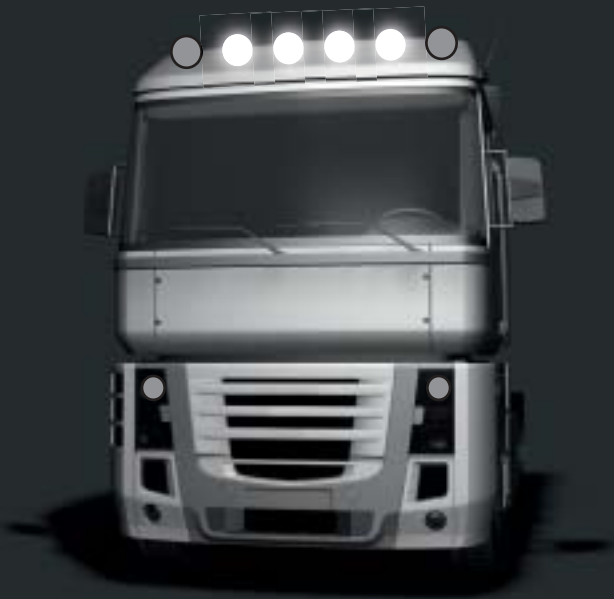
Vybavení: ⊗ ⊗ / ● ○ ○ ○ ○ ○ ● 2 x SF ref. 37,5 (2x odpojeno) + 6 x ZF ref. 17,5 (2x odpojeno) Celkový součet = ref. 70 (dovolen)
