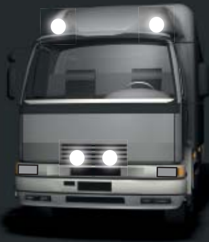
Vybavení: ☒☒ / ○○ / ○○ 2 x SF ref. 37,5 (2 odpojen) + 4 x ZF ref. 25 Celkový součet = ref. 100 (max. dovoleno)
