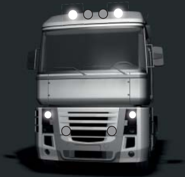
Vybavení: ⊗ ⊗ / ● ● / ○ ● ● ○ 2 x SF ref. 17,5 + 6 x ZF ref. 25 (4x odpojeno) Celkový součet = ref. 85 (dovolen)
