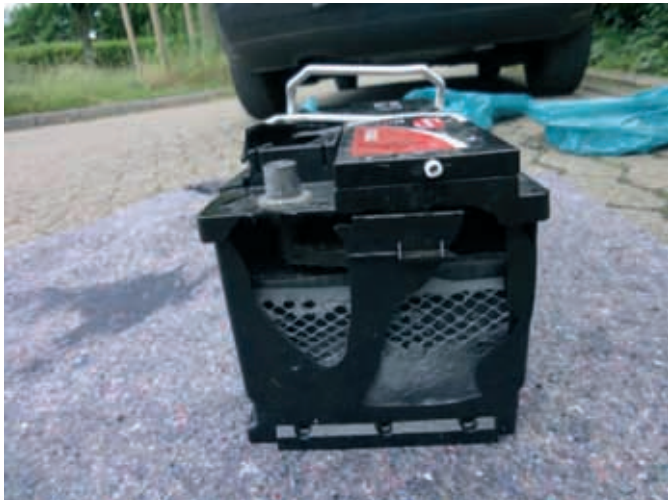
Silné poškození: Plášť baterie a mřížka Možná příčina: Přebití nebo obrácený režim nabíjení
