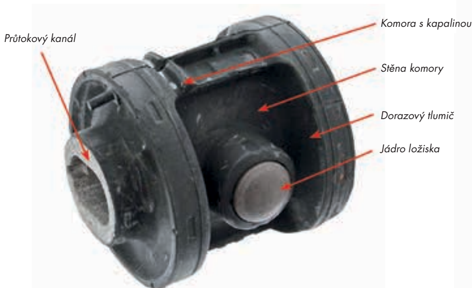
Obr. 1: Uspořádání hydroložiska (bez vnějšího pouzdra)
