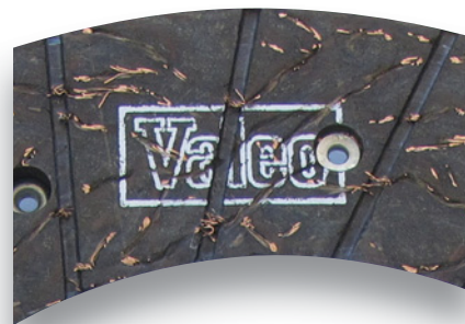
Speciální obložení s nízkým koeficientem opotřebení vyvinuté pro spojky HEC.
